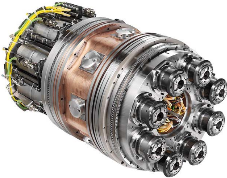
Bild 004: Die thermostabile Spindeltrommel als Garant für hochpräzise Werkstücke.
